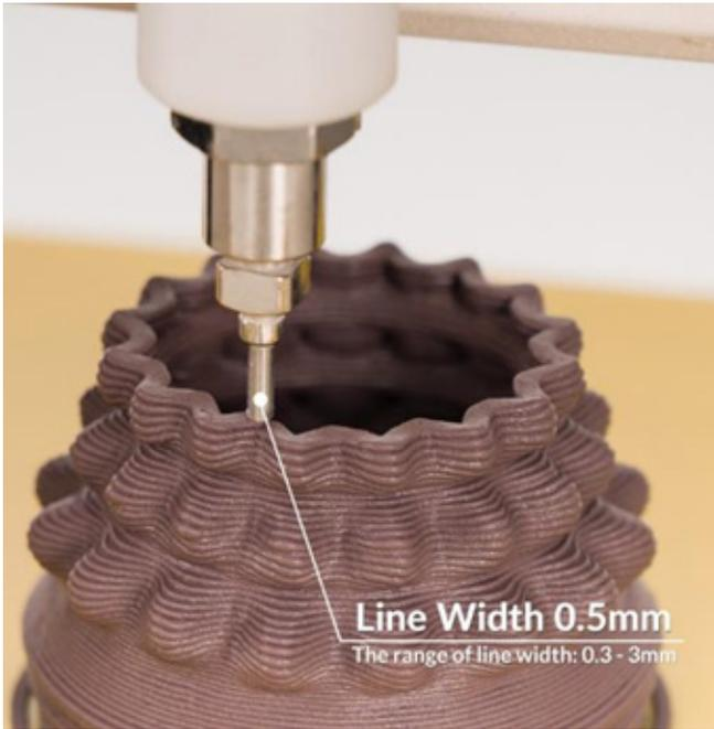
Figura 25. Boquilla para impresión 3D con arcilla.
