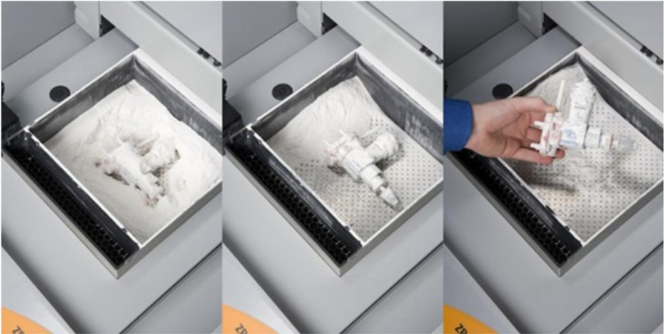
Figura 10. Proceso de impresión 3D SLS.
