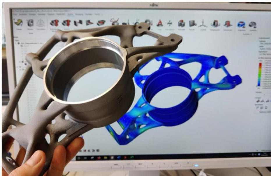
Figura 52. Pieza mecánica realizada con impresión 3D.
