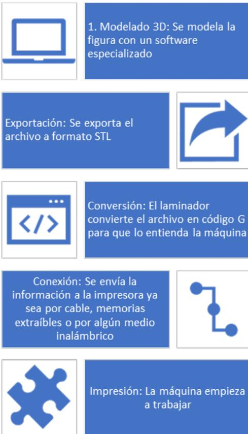
Figura 4. Etapas del proceso de impresión 3D.
