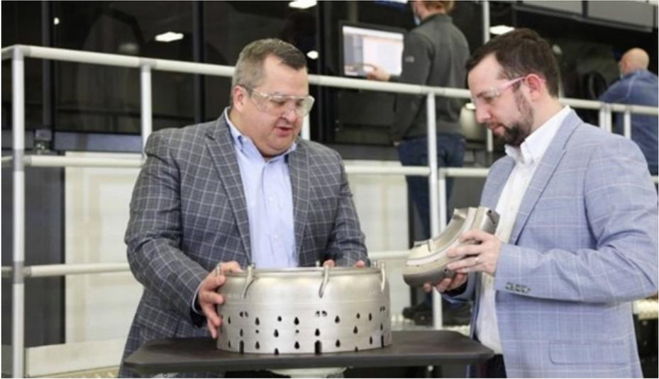
Figura 14. Componentes de motores fabricados con impresión 3D.
