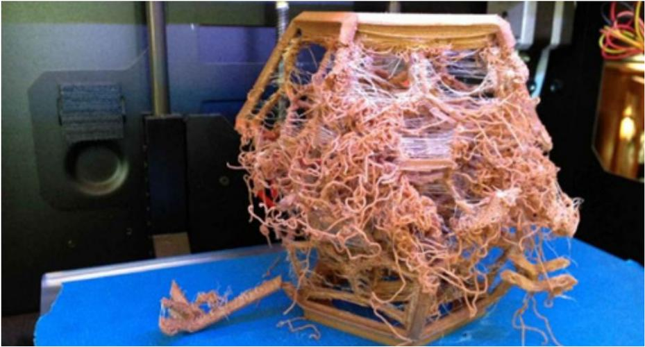
Figura 50. Error al realizar la impresión 3D.
