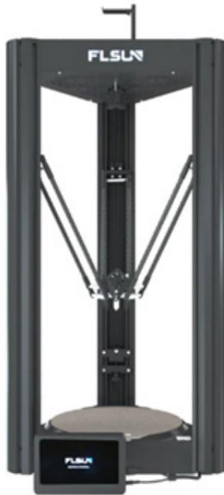
Figura 31. Impresora 3D de tipo delta, marca FLSUN.
