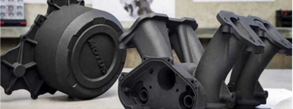
Figura 22. Piezas impresas con fibra de carbono.
