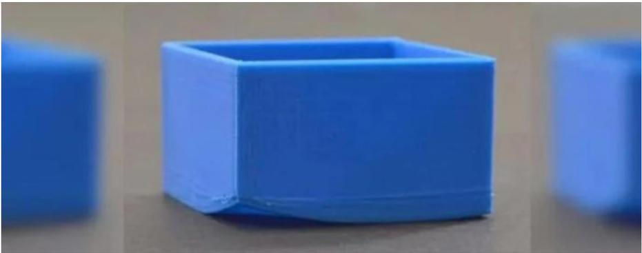
Figura 49. Fenómeno de Warping en una impresión 3D.
