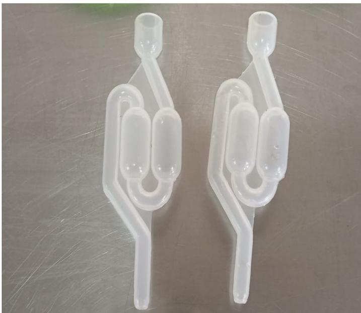
Figura 4. Instrumentos para el control de procesamiento: Airlock.
