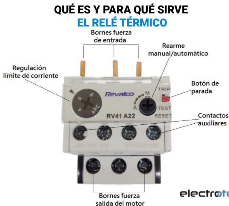
Figura 6.6. Relé Térmico.
